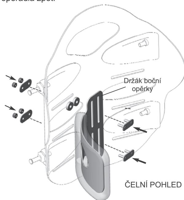
**1 Poznámka:** Dolní montážní drážky nejsou u opěradel MaTRx-PB elite vysokých 31cm (12") k dispozici.
