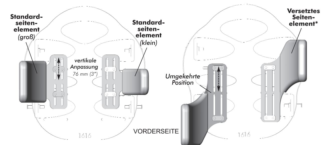
**Hinweis:** Versetzte Seitenelemente können auch in umgekehrter Position (wie abgebildet) montiert werden, um eine erweiterte Unterstützung zu erreichen.
