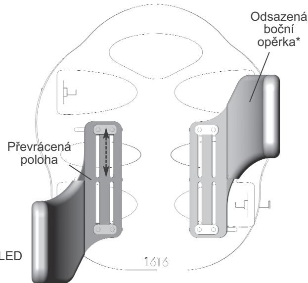
**\* Poznámka:** Odsazené boční opěrky lze montovat také v převrácené poloze (znázorněné na ilustraci), v níž poskytují prodloužené podepření.
