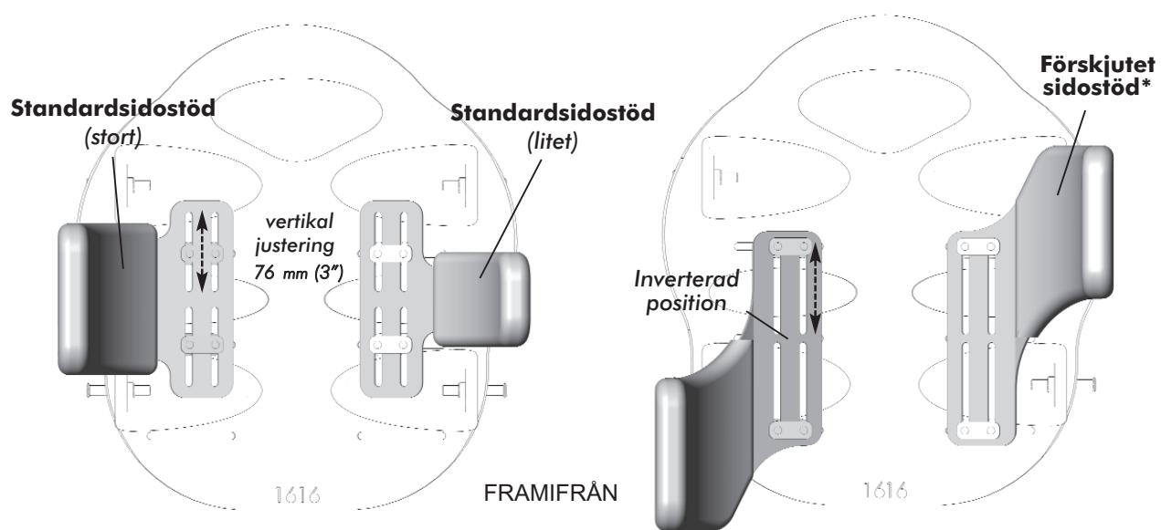
**Obs!** Förskjutna sidostöd kan också monteras i inverterad position (enligt bild) för att ge utökat stöd
