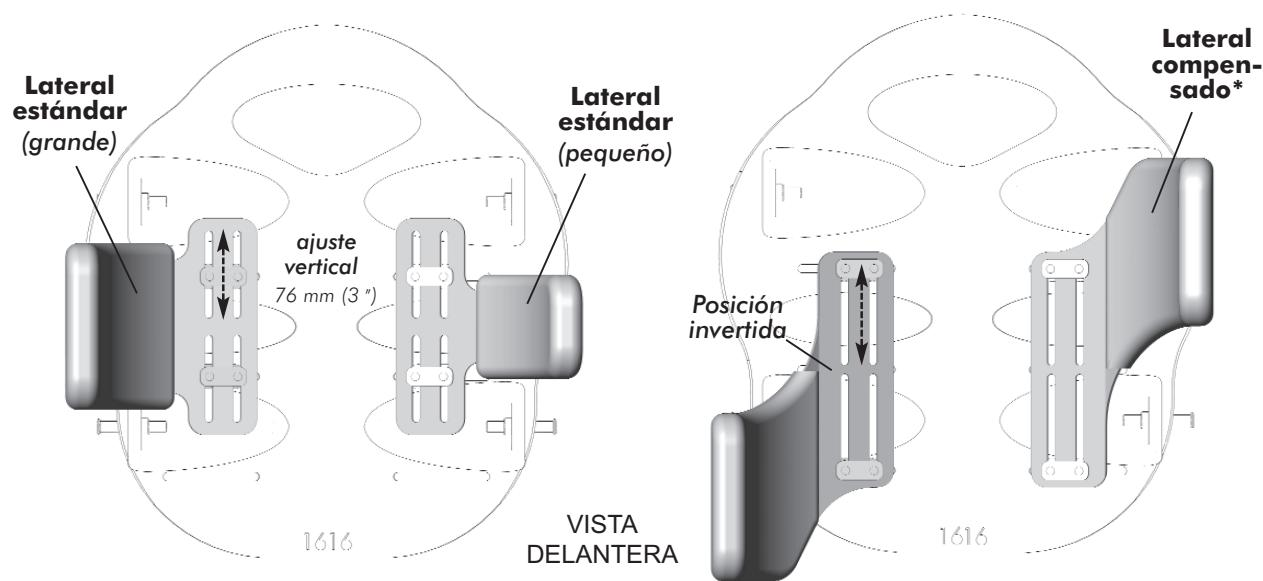
\*nota: los laterales compensados también pueden montarse en posición invertida (como se muestra en la ilustración) para proporcionar mayor soporte
