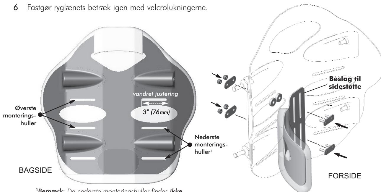
**Bemærk:** De nederste monteringshuller findes *ikke* på TRx-PB elite ryglæn, der er 12" (31cm) høje
